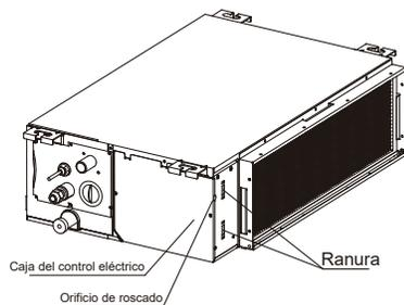
Figura 41 : Caja del control eléctrico
